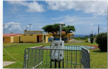
Appareil de mesure DA80 positionné sur le site de Bélair, Capesterre-Belle-Eau, pour la surveillance des pesticides
